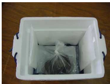
3. Se introduce la muestra procurando que las barras de gel congelado queden alrededor de la muestra.
