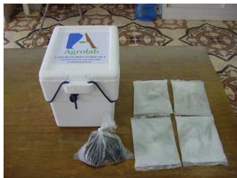
2. Se congela el gel y la muestra se coloca en una bolsa plástica perfectamente identificada.
