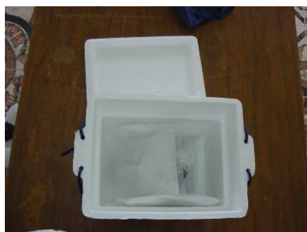
4. Se cubre totalmente la muestra con las barras de gel congelado.
